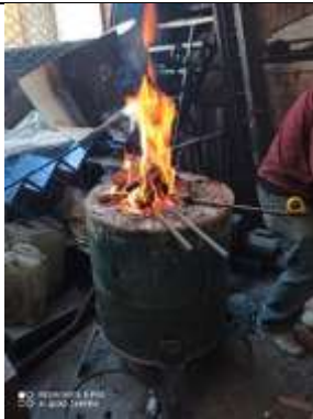
Construcción de una fragua para el forjado de hierro en caliente
