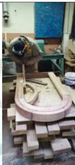
Ensamblado de puerta para muro de cortina
