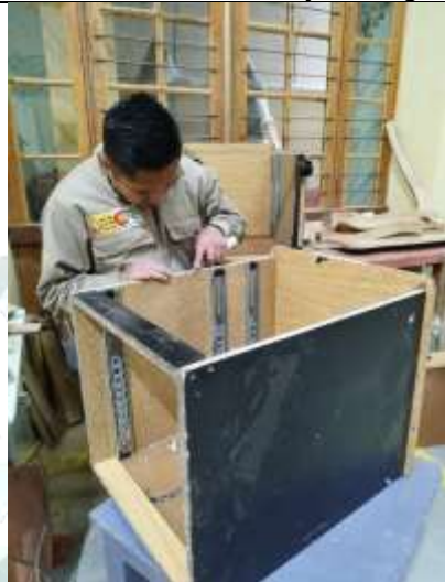
Restauración de gaveteros de 3 cajas consolidación de tableros y las cajas en proceso
