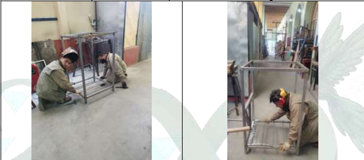
Construcción de contenedores de metal para botellas pett
