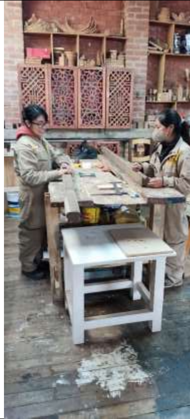
Elaboración de pasamanos para el barandado de las gradas en Juancito Pinto
