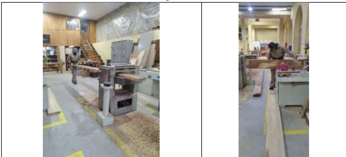
Maquinado de madera para la escalera del taller de Talla (en proceso)
