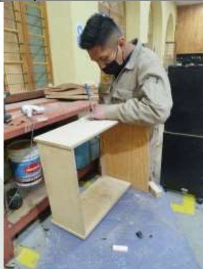
Restauración de gaveteros de 3 cajas consolidación de tableros y las cajas en proceso
